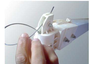
7º Passo: desenrolar o cabo de aço. Passá-lo pela roldana da conexão plástica da ponta.
