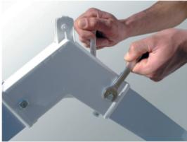
4º Passo: colocar e apertar os parafusos da conexão plástica, deixando-a totalmente fechada e presa nas hastes.
