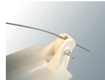
8º Passo: Encaixar a armação na haste e prenda com o parafuso. Passar o cabo pela roldana do meio.
