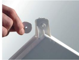
5º Passo: encaixar a roldana plástica e apertar o parafuso o suficiente para encostar as partes da conexão, mas sem prender a roldana, de modo a permitir a passagem do cabo de aço posteriormente.
